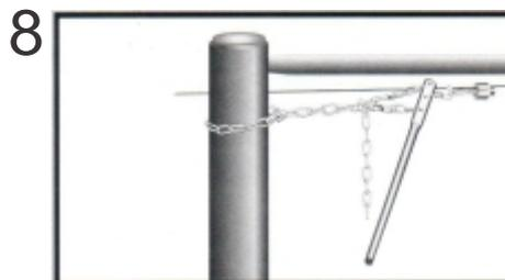
8 Sem retirar o esticador do lugar, corte o arame com tamanho suficiente para dar 3 ou 4 voltas inteiras no eixo da catraca. Faça com que o arame não fique entre o furo do eixo e a lateral da catraca, evitando assim deformá-la.
