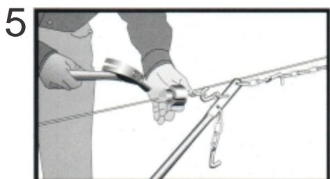
5 Coloque o arame na mordça utilizando-se do rasgo nele existente (de preferência do lado oposto do rasgo), de tal forma que o arame não escape. Bata com um martelo no pino cônico até que o arame fique preso e não deslize.
